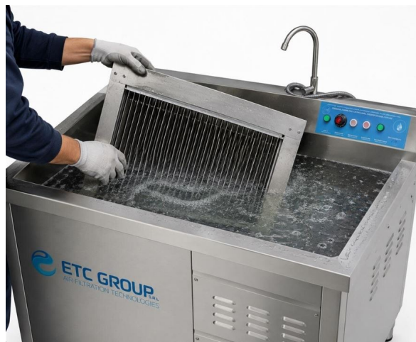
Fig. 5 – Lavaggio del filtro elettrostatico in vasca a ultrasuoni
