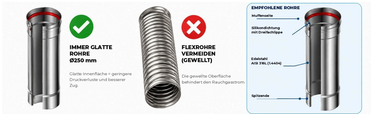
Abbildung 12 – Pizzaöfen: glatte Rohre Ø250 verwenden (links), gewellte Flexrohre vermeiden (rechts).
