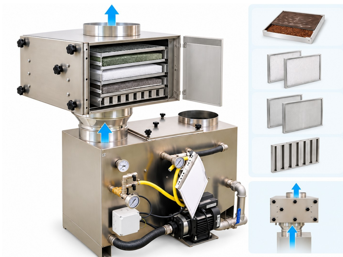
Figura 20 – FilterPack montado en la salida de la máquina: colector, airbox con las ranuras para los filtros y salida del aire; a la derecha, los medios filtrantes aplicables.
