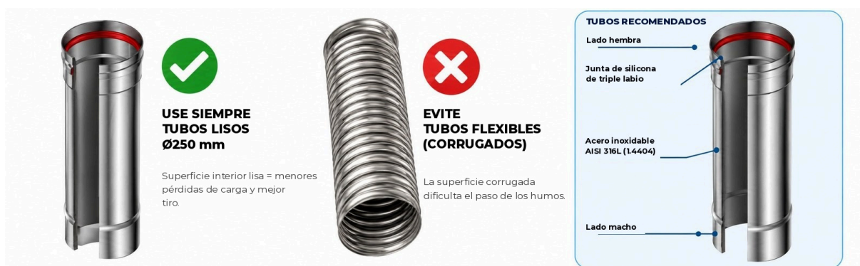
Figura 12 – Hornos de pizza: use tubos lisos Ø250 (a la izquierda), evite los flexibles corrugados (a la derecha).
