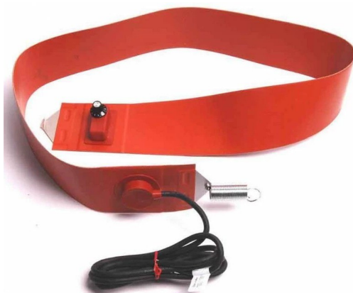
Tappeto riscaldante antigelo in silicone (optional): regolazione della temperatura a manopola, molla di fissaggio e cavo di alimentazione.
