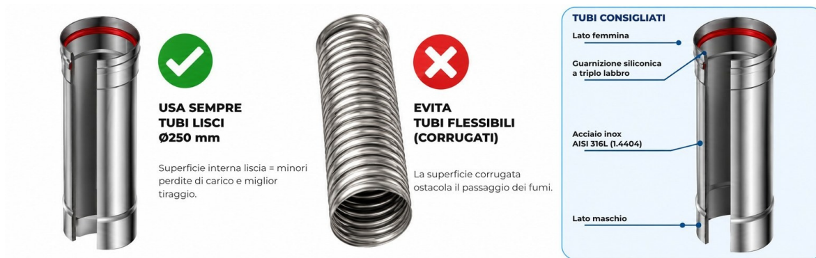
Figura 12 – Forni pizza: usare tubi lisci Ø250 (a sinistra), evitare i flessibili corrugati (a destra).
